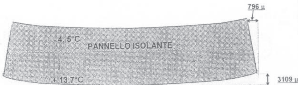
Figura 10: DEFORMAZIONE NON CONTRASTATA DEL PANNELLO ISOLANTE STAGIONE INVERNALE
